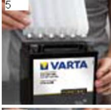
Приблизительно через 30 минут после заливки электролита следует измерить вольтметром напряжение аккумуляторной батареи. Если значение выше 12,7 вольт, то аккумуляторная батарея сразу готова к эксплуатации. Если напряжение ниже, то батарее необходимо подзарядить (смотри пункт 4).
