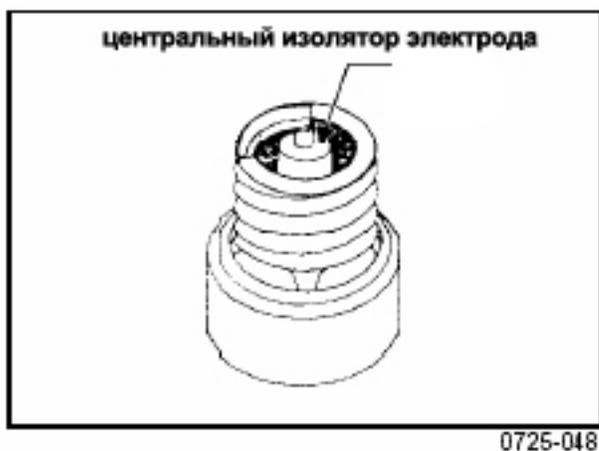
А. Рыжевато-коричневый или светло-коричневый цвет изолятора, указывает на правильную работу свечи зажигания.
